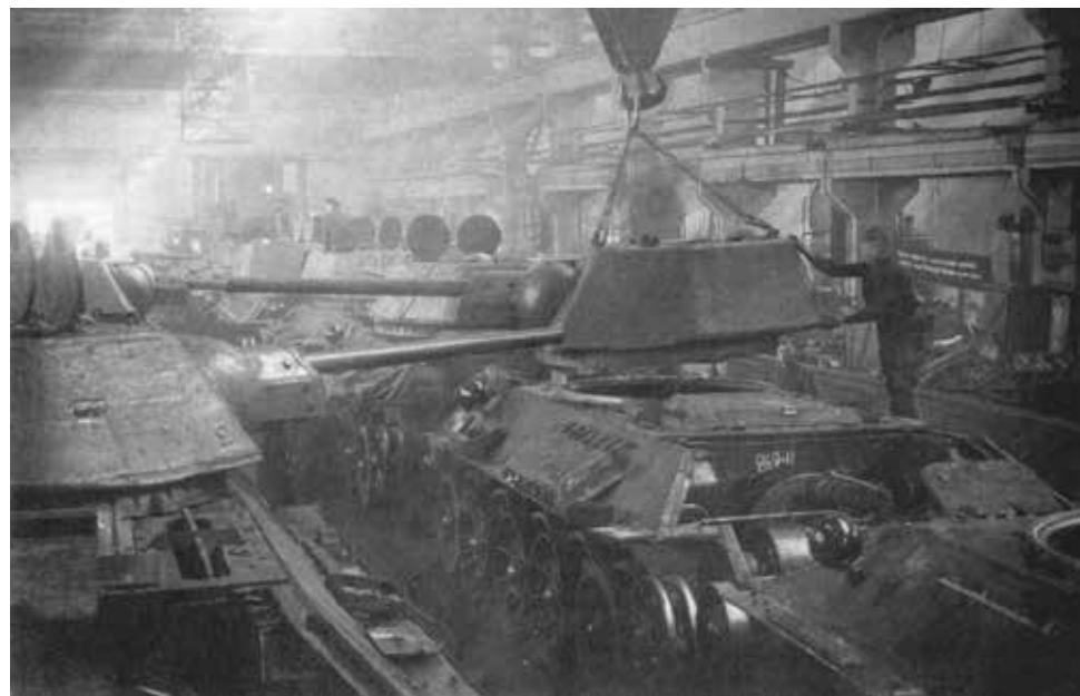
Установка башен на конвейер окончательной сборки танков Т-34.
