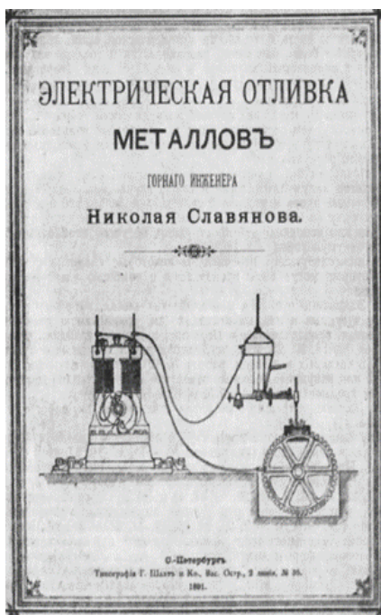
Свой способ соединения металлов Н.Г. Славянов назвал "отливкой" Схема сварочного аппарата Николая Гавриловича - "плавильник".
