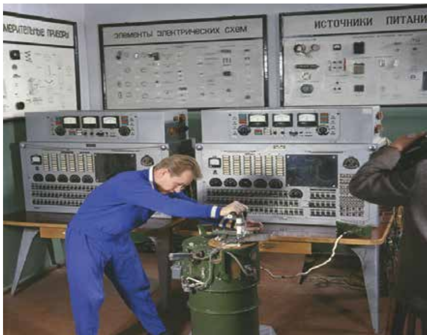
Советская установка «Вулкан» для дуговую, плазменную и электронно-лучевую сварку.
