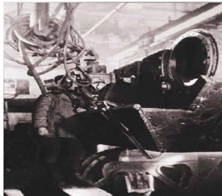
Автоматизированная сварка броневых танковых плит по методу академика Патона
