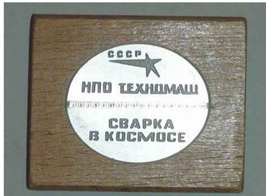
Образец сварки, выполненной в космосе в 1980-е годы
