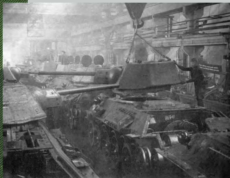
Установка башен на конвейер окончательной сборки танков Т-34 Уральского танкового завода № 183 в Нижнем Тагиле. Фото: Российский Государственный архив экономики
